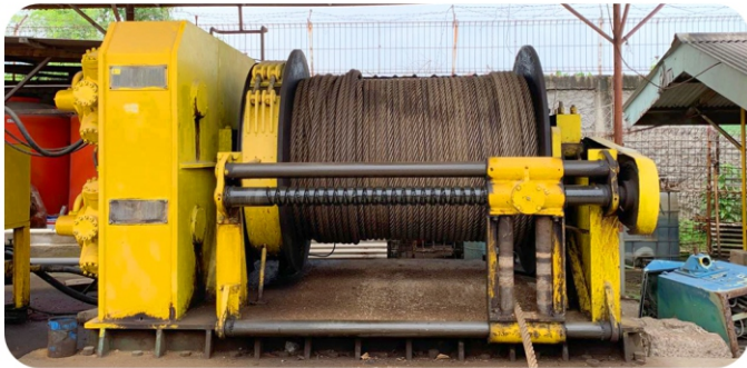
WINCH 85019 Kapasitas : 280 Ton
