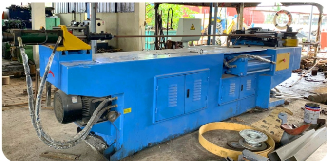
MESIN BENDING PIPA Kapasitas : 2.5 Inch
