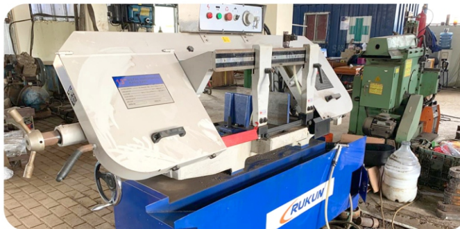
BENDSAW HORIZONTAL Kapasitas : 330 MM
